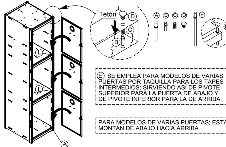
(E) SE EMPLEA PARA MODELOS DE VARIAS PUERTAS POR TAQUILLA PARA LOS TAPES INTERMEDIOS; SIRVIENDO ASÍ DE PIVOTE SUPERIOR PARA LA PUERTA DE ABAJO Y DE PIVOTE INFERIOR PARA LA DE ARRIBA
